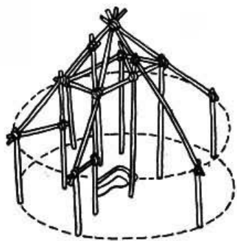
仰韶文化的半穴居圆形房子(半坡遗址3号房子) 左 平面图 中 构架示意图 右 复原图
